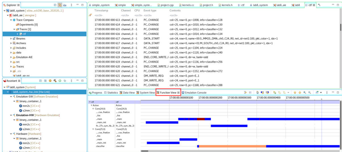
图 41：显示每个 AI 引擎上正在运行和已停滞的内核以及 main 函数的函数视图
